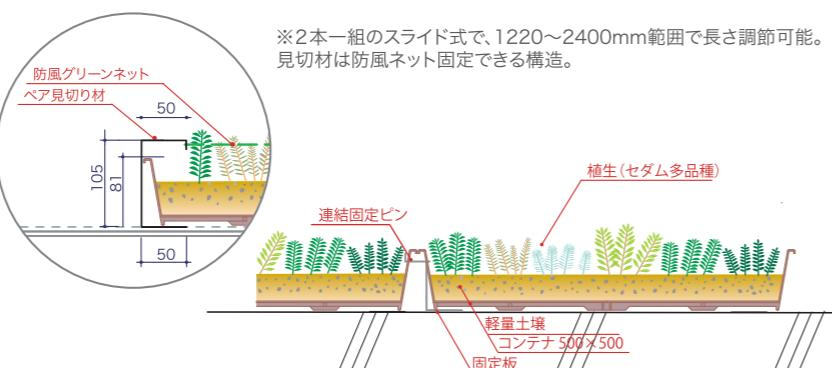
屋根材を痛めず安心 VUS500 金属屋根緑化専用固定金具
